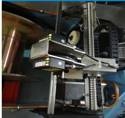
采用独立的排线控制，内部有一套独立PLC（AM400），可进行精密排线部分编程
