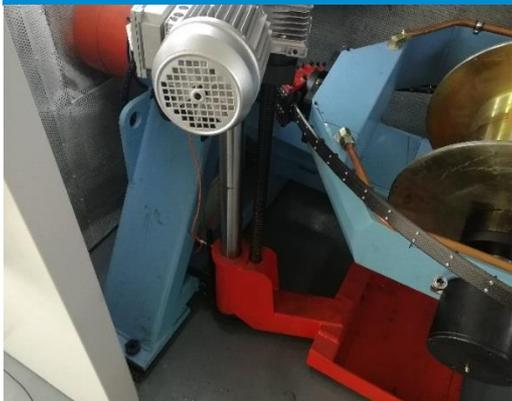
外部的MD810变频器（23位编码器）控制异步电机驱动束线绞弓进行高精度旋转
