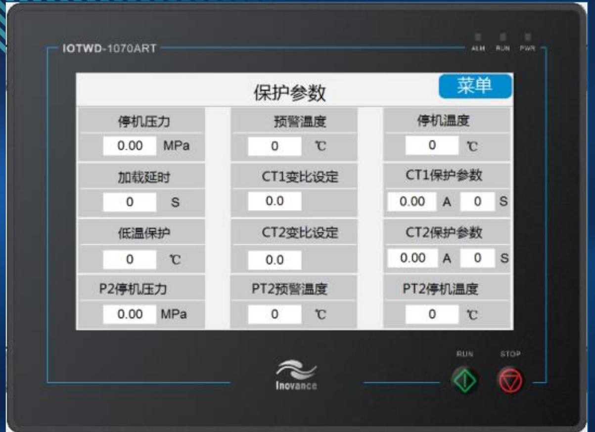
备注：P2跟PT2保护参数默认不显示，如果有应用，请到厂家参数选择功能开启，开启后相对应的P2压力跟PT2温度在主页面工艺流程图上显示。
