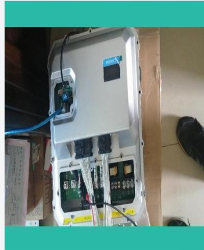
CV800系列一体机采用压铸一体成型外壳，体积相比CV600更小，重量更轻，且集成了电子膨胀阀驱动，接口更加丰富，EMC等级更高。
