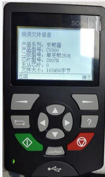
SOP键盘—更新变频器底层软件
